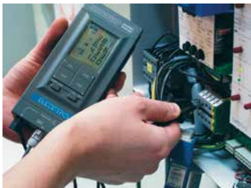
Figur 10.6. Ved måling af effekt anvendes et wattmeter.
