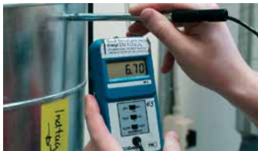
Figur 10.1. Varmetrådsanemometer for måling af luft hastighed.
