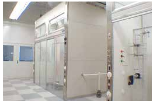
Figur 6.1. Total indkapslet proces (lukkede kabinetter).
