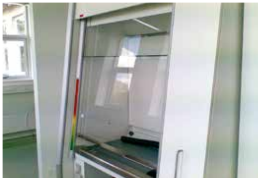
Figur 6.2. Delvis indkapslet proces (stinkskab).
